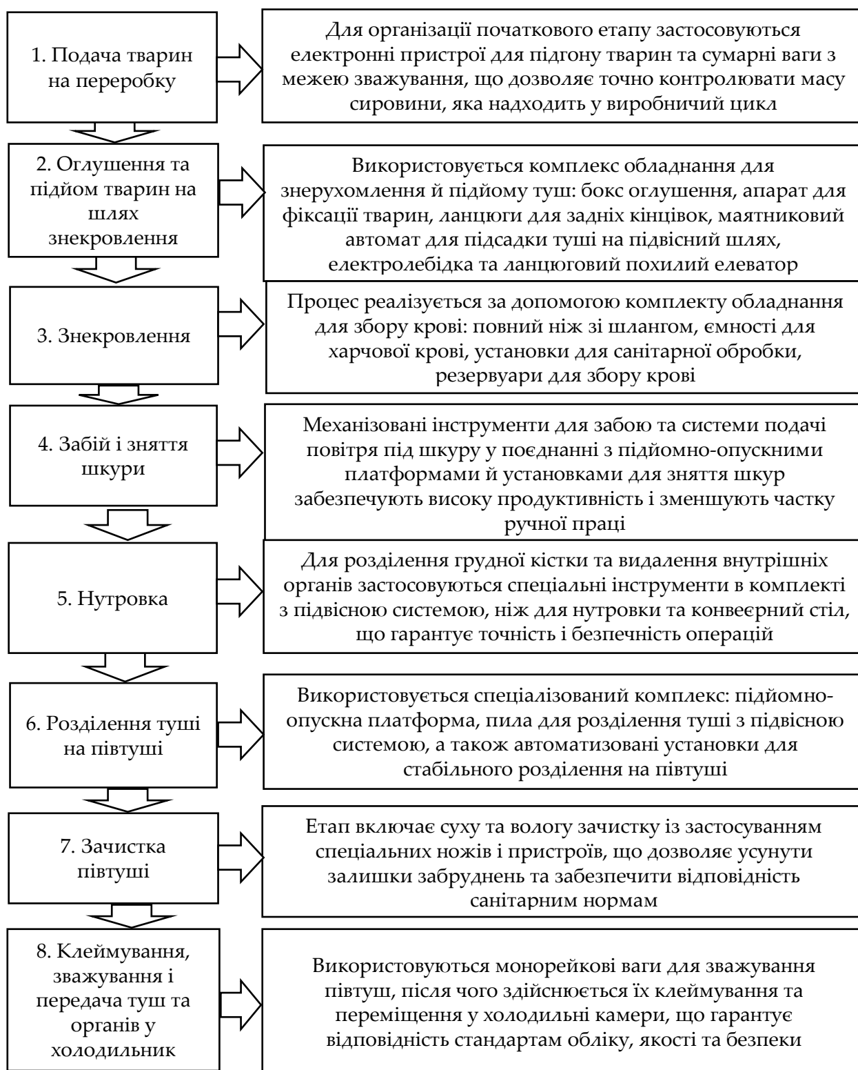
Рис. 1. Технологічна схема виробничого процесу м'ясопереробного підприємства із зазначенням основного обладнання (розроблено, побудовано авторами)
