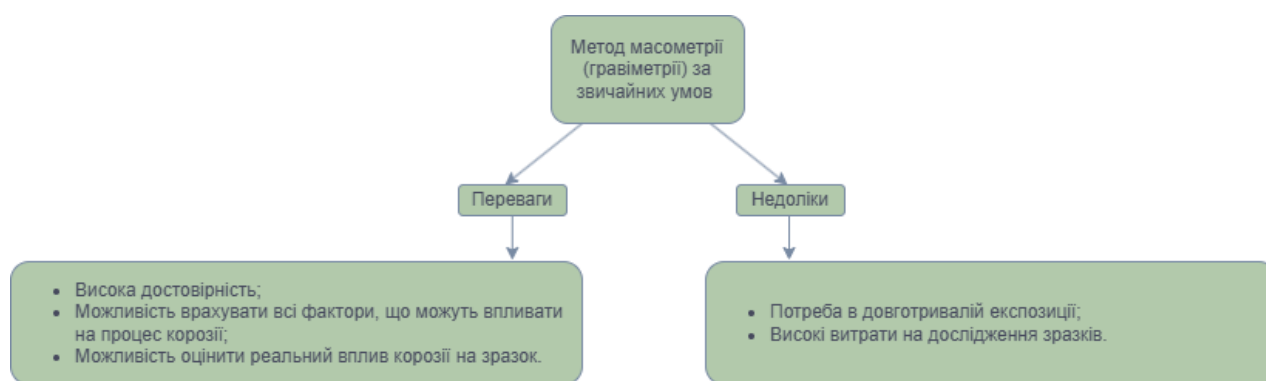
Рис. 2. Переваги і недоліки вимірювання швидкості корозії за допомогою методу масометрії (гравиметрії) за звичайних умов
