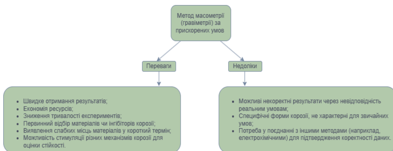
Рис. 3. Переваги і недоліки вимірювання швидкості корозії за допомогою методу масометрії (гравіметрії) за прискорених умов
