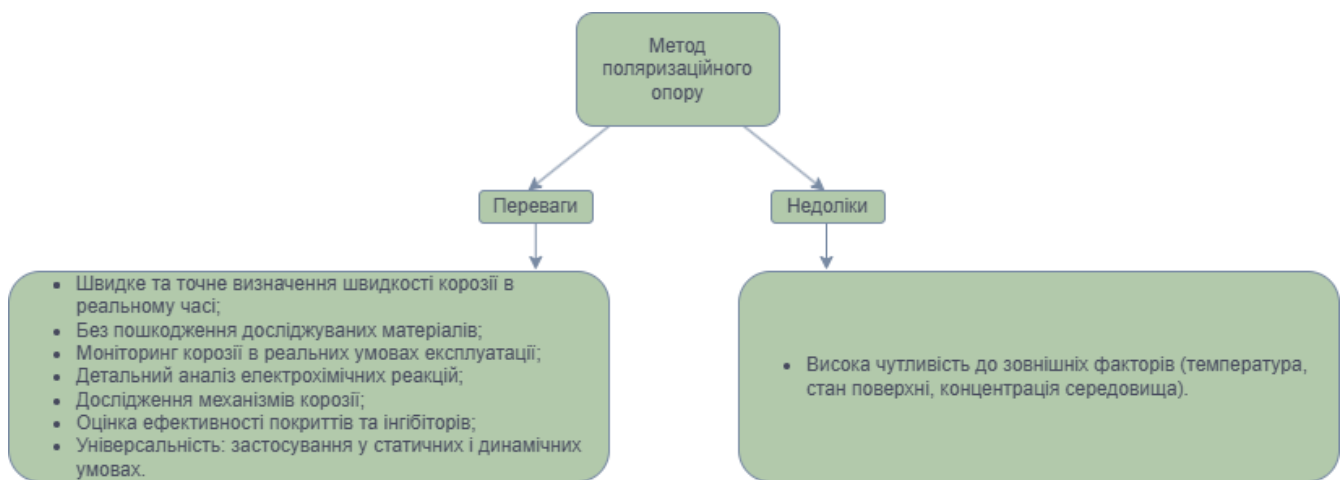
Рис. 4. Переваги і недоліки вимірювання швидкості корозії за допомогою методу поляризаційного опору
