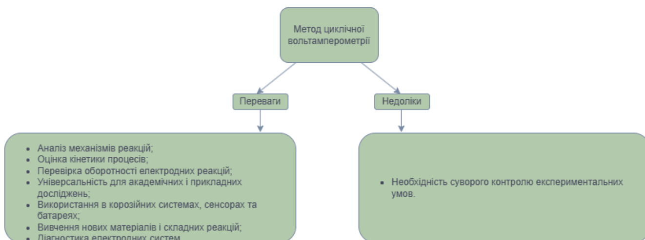
Рис. 5. Переваги і недоліки вимірювання швидкості корозії за допомогою методу циклічної вольтамперометрії
