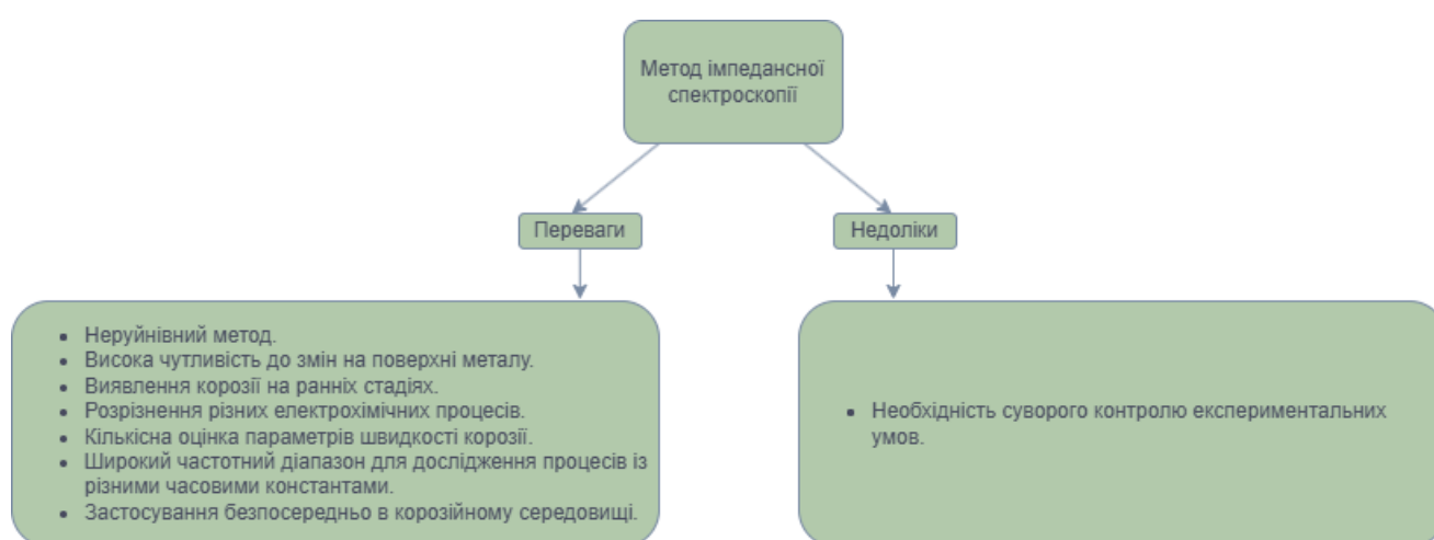
Рис. 6. Переваги і недоліки вимірювання швидкості корозії за допомогою методу імпедансної спектроскопії
