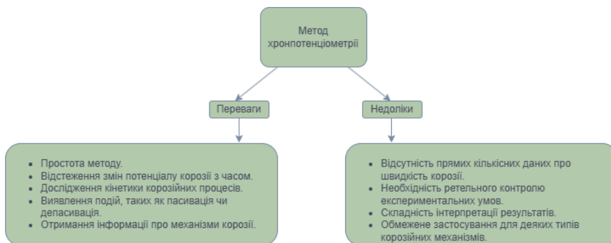
Рис. 7. Переваги і недоліки вимірювання швидкості корозії за допомогою методу хронопотенціометрії
